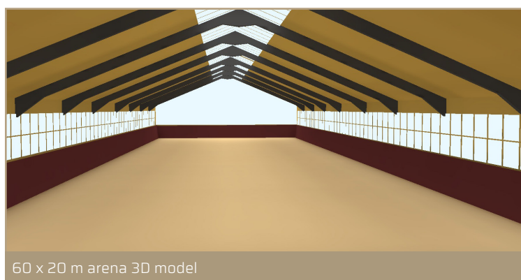
Dialux simulation 36 luminaires (Average illuminance 386 lx - Uniformity 0.74)
